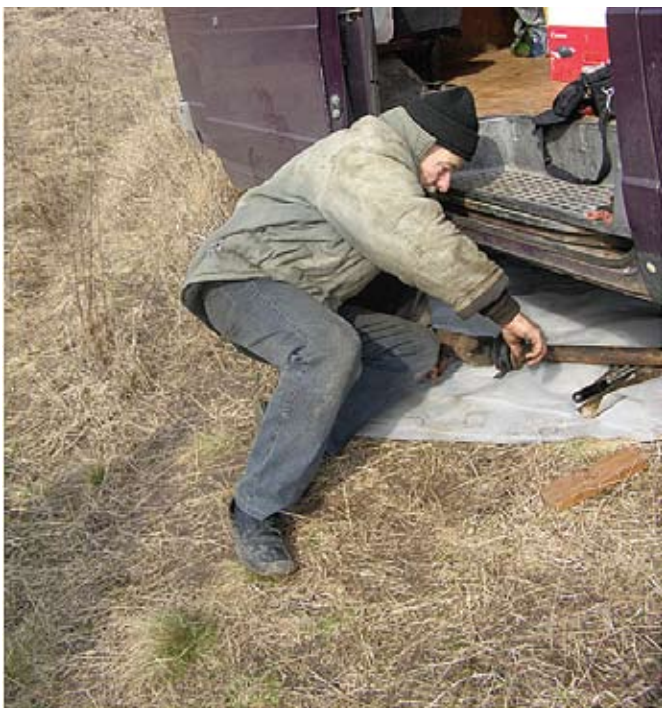
Viktor byter packning i kardanknuten
